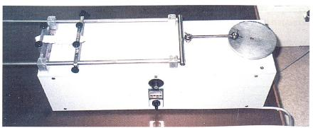
Abbildung 1: Prüfgerät für elastische Bänder
