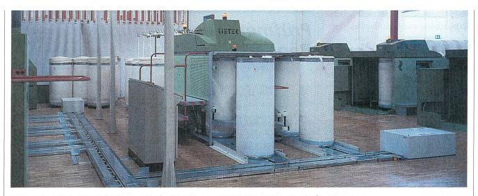
Transportlogistik: Automatischer Kannentransport (vorn), Hängetransportsystem für Flyerspulen (binten)
