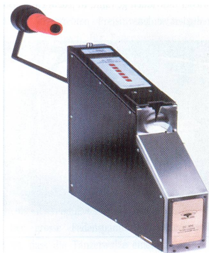
Der neue Automat Ascolite MMS Mark 10 bewältigt das Umwickeln, Verschweissen und Abschneiden in einem Arbeitsgang von 1 Sekunde
