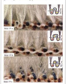
Bild 19a-c: Möglichkeiten der Einbindung der W-Noppe bei einer 4/8-Bindung am Beispiel des Stehpoles
