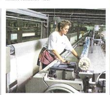
Abb. 2: Die meisten Maschinen bei Synthetic Industries sind Projektilwebmaschinen von Sulzer Textil, in erster Linie vom Typ P7100, die in verschiedenen Werken Millionen von Metern technischer Gewebe produzieren – genutzt z. B. zur Abtrennung weicher Erdschichten beim Strassenbau.
