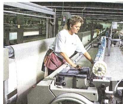
Abb. 2: Die meisten Maschinen bei Synthetic Industries sind Projektwebmaschinen von Sulzer Textil, in erster Linie vom Typ P7100, die in verschiedenen Werken Millionen von Metern technischer Gewebe produzieren – genutzt z. B. zur Abtrennung weicher Erdschichten beim Strassenbau.
