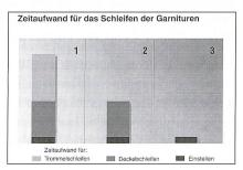
Fig. 7: Mit IGS-classic und -top reduziert sich der Wartungsaufwand auf eine Korrektur der Einstellungen alle 100 bis 200 t
