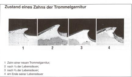
Fig. 2: Dauernd scharfe Spitzen der Trommelgarnituren sind Voraussetzung für konstante Kardierqualität
