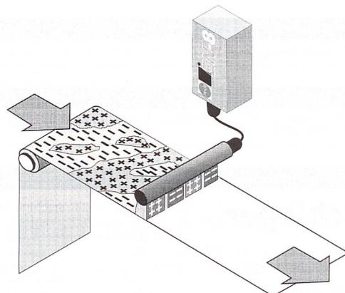
Statische Aufladungen führen in vielen Fertigungsprozessen zu Störungen. HAUG-Ionisationssysteme lösen dieses Problem bei der Folien- und Papierverarbeitung sowie in der Textil- und Kunststoffindustrie.
