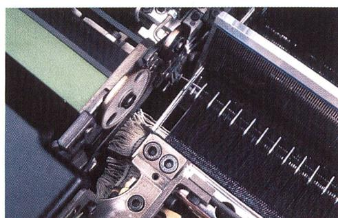
Abb. 1.: Vergleich der Kantenbildung an einer Projektilwebmaschine, links ohne Hilfskante, rechts mit Hilfskante
