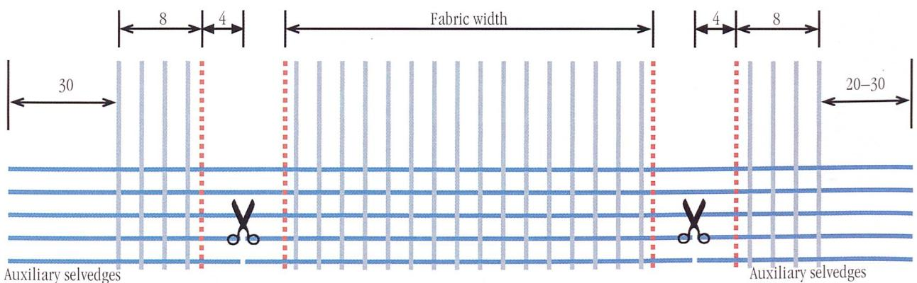
Abb. 2: Vergleich der Kantenbildung an einer Greiferwebmaschine.
