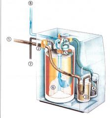
Abb. 1: Pure Water RO 400: 1. Robwasser, 2. Zulaufsieb, 3. Mikrofilter, 4. Aktivkohlefilter, 5. Umwälzpumpe, 6. semi-permeable Membrane, 7. Konzentrat, 8. Reinwasser
