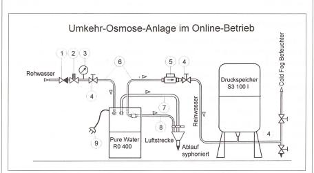
Abb. 2: Umkebr-Osmose: 1. Rückschlagventil, 2. Druckreduziereinheit, 3. Manometer, 4. Abstellhahn, 5. Durchflusszähler, 6. Panzerschlauch, 7. Konzentratablauf, 8. Spülung Reinwasser, 9. Elektroanschluss 230 V/50 Hz, 10 A
