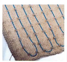
Abb.1: Einlegetechnik am Beispiel eines eingelegten Kabels
