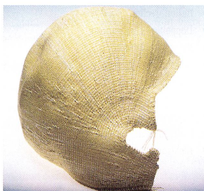
Abb. 2: Karkasse für Schutzhelm, gestrickt aus Aramid- und Glasfasern
