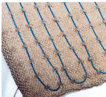
Abb. 1: Einlegetechnik am Beispiel eines ein-gelegten Kabels
