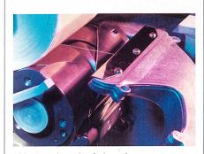
Abb. 2: Sicher Oberfadenerfassung am Autoconer 338
