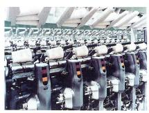
Abb. 1: Autoconer – die neue Spulmaschinengeneration
