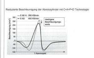
Abb. 2: Bewegungsverlauf der Abreisszylinder
