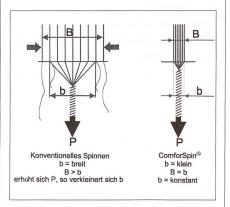
Abb. 3: Garnbildung beim ComforSpin®-Verfahren
