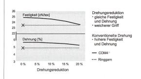
Abb. 5: Flexibilität durch Drehungsreduktion – COM4®
