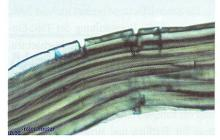
Geschädigtes Elastan, mit Methylenblau angebärbt, 100:1 im Durchlicht/Hellfeld
