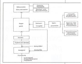
Abb. 6: Regelung der Fadenzugkraft an der Nähmaschine beim Ärmeleinnähen
