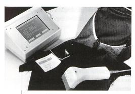
Abb. 3: Das Produktionsleitsystem mit Bare-Code-Leser zur Bereitstellung der Produktionsdaten am Arbeitsplatz
