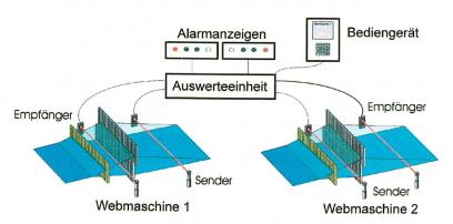
Bild 1: Schematische Darstellung der Überwachung von zwei Webmaschinen (Schematic view of two monitored looms)
