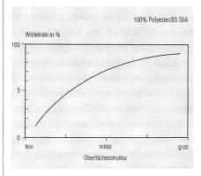
Abb. 7: Einfluss der Oberflächenrauheit auf die Wickelneigung
