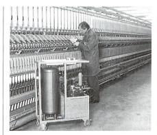
Abb. 11: Unterwalzenschmiergerät Berkol<sup>®</sup> Lubribov
