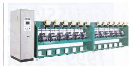
Abb. 1: DREF2000 12-Kopf-Friktionsspinnmaschine
