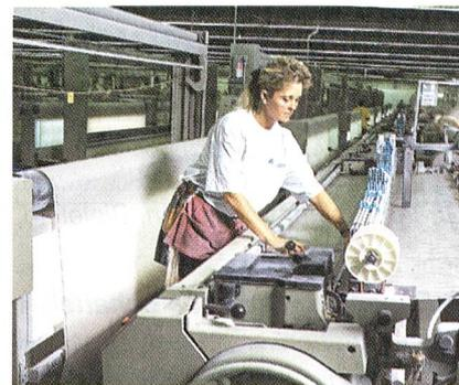
Abb. 2: Die meisten Maschinen bei Synthetic Industries sind Projektilewebmaschinen von Sulzer Textil, in erster Linie vom Typ P7100, die in verschiedenen Werken Millionen von Metern technischer Gewebe produzieren – genutzt z. B. zur Abtrennung weicher Erdschichten beim Strassenbau.
