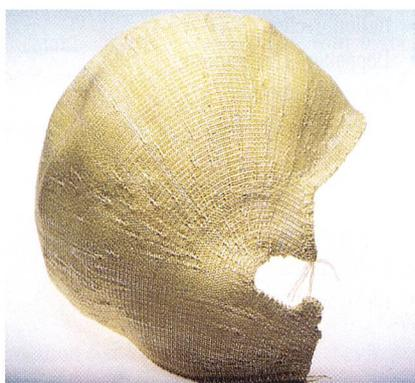
Abb. 2: Karkasse für Schutzhelm, gestrickt aus Aramid- und Glasfasern
