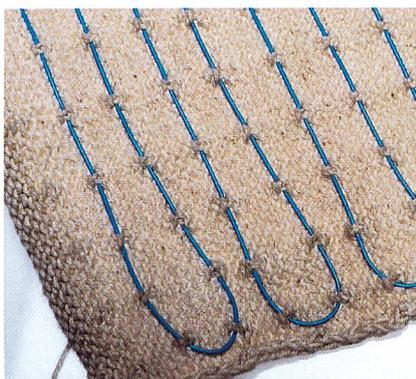
Abb. 1: Einlegetechnik am Beispiel eines eingelegten Kabels
