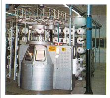
Ein Wanderreiniger von SOHLER AIRTEX an einer Rundstrickmaschine von Terrot Foto: SOHLER AIRTEX
