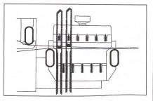
Abb. 2: Niederbaltevorrichtung zur zusätzlichen Schonung der Kettfäden, Grob, Horgen (CH)
