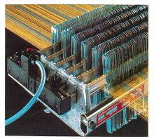
Abb. 1: elektrischer Kettfadenwächter Grob, Horgen, CH
