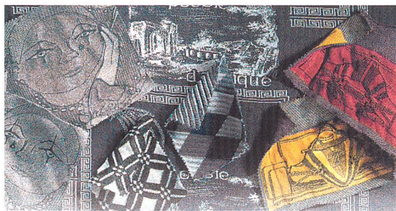
Abb. 4: Beidseitig Volljacquard in Design und Struktur von RR-Jacquard-Rundstrickmaschine MAYER OVJA 1.6 EE
