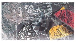
Abb. 4: Beidseitig Volljacquard in Design und Struktur von RR-Jacquard-Rundstrickmaschine MAYER OVJA 1.6 EE
