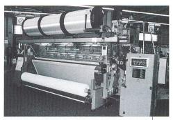
Abb. 6: Hochleistungs-Kettenwirkautomat MAYER HKS 3-1 EBA
