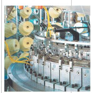
Abb. 3: RR-Jacquard-Transfer-Rundstrickmaschine mit Piezo-Technik TERROT UCC 548- T
