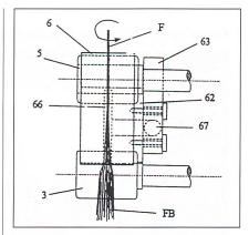
Abb. 3 c: Draufschicht auf die Transportebene aus der Richtung unterhalb der Streckwerkszylinder
