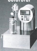
HT Färbeapparat für Web- und Wirkware, Garn, Strang und Flocke, Flottenumwälzung mittels Zahnradpumpe, Durchflussrichtung reversierbar, Optionen wie Regelsystem für Durchfluss und Differenzdruck, Dosieren, Flottenentnahme, pH-Steuerung
