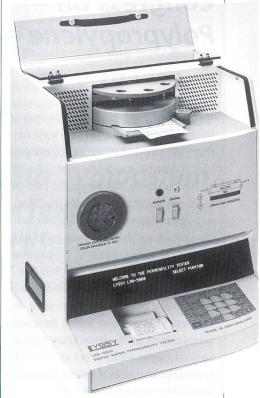
Automatisches Wasserdampf-Durchlässigkeits-Messgerät Foto: Toni Küng
