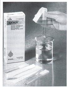
Bild 1: Queen's Award for Technological Achievement. Testen der Saugfähigkeit von Hydrocel
