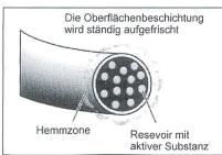
Abb. 2: Die antibakterielle Wirkung von BIOKRYL ist in die Faserstruktur eingearbeitet Foto: Acordis
