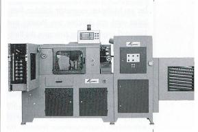
Abb. 2: Schleifautomat BSS/AM mit vollintegriertem Berkolisiermodul
