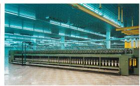
Abb 2: RO-WE-MAT 670 — Flyer mit integriertem Spulenwechsler Fig. 2: RO-WE-MAT 670 — the Flyer with integrated doffer
