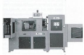
Abb. 2: Schleifautomat BSS/AM mit vollintegriertem Berkolisiermodul
