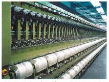
Abb 4: Streckspulmaschine 549 – Für technische und textile Anwendungen von Synthesefasern
