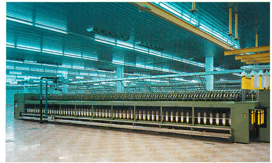
Abb 2: RO-WE-MAT 670 – Flyer mit integriertem Spulenwechsler
