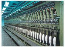
Abb. 5: Streckzwirneinheit 525 – Für technische und textile Anwendungen von Synthesefasern
