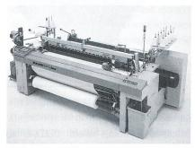
Abb. 4: L5200 Luftdüsenwebmaschine von Sulzer Textil
