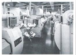
Abb. 1: Die Reihenfachwebmaschine M8300 von Sulzer Textil
