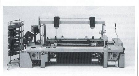
Abb. 2: G6200 Greiferwebmaschine von Sulzer Textil
