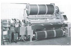
Abb. 10: Picanol-Günne Frottierwebmaschine (Luftdüse)
