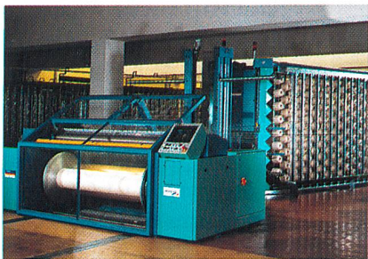
Abb. 1: Die Zettelmaschine BE-DIRECT für Geschwindigkeiten bis zu 1200 m/min Fig. 1: The direct warper BEN-DIRECT for speeds up to 1200 m/min
