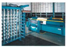
Abb. 2: Schärmaschine BEN-TRONIC Fig. 2: Sectional warper BEN-TRONIC
