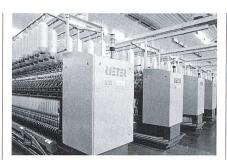
Abb. 3: Die Ringspinnmaschine G 33
