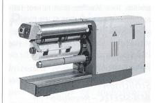
Abb. 5: Rieter CD 300 Winder (alle Abbildungen Rieter Textile Systems)
