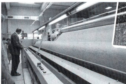
Die neuen Anlagen lassen die Herstellung von Nähwirk-Vliesstoffen bis zu 5,7 m Breite zu
