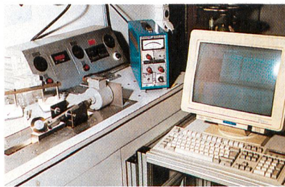
Abb. 3: EMPA-Prüfgerät zur Ermittlung der Reibung von Socken alle Fotos: DuPont
