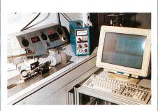
Abb. 3: EMPA-Prüfgerät zur Ermittlung der Reibung von Socken alle Fotos: DuPont
