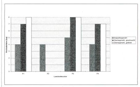
Rückhaltevermögen verschiedener Fügeverbindungen in Laminaten von Escherichia Coli (ATCC 11229) im feuchtnassen Milieu (Blut) unter Druckeinwirkung von 200 g/cm² (Penetrationstest Methode I nach Dr. Mergeryan, Universtätsklinikum Göttingen)
