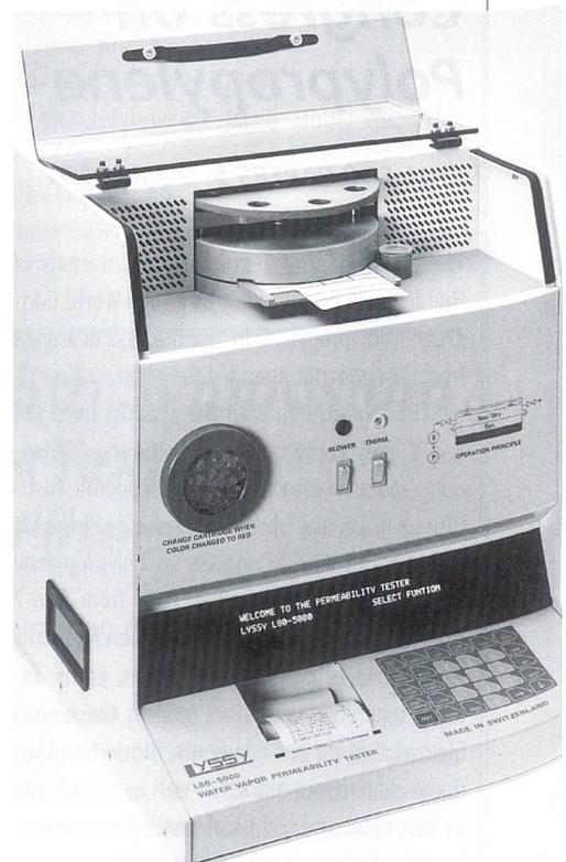
Automatisches Wasserdampf-Durchlässigkeits-Messgerät Foto: Toni Küng
