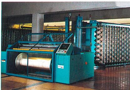
Abb. 1: Die Zettelmaschine BE-DIRECT für Geschwindigkeiten bis zu 1200 m/min
