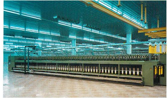
Abb 2: RO-WE-MAT 670 – Flyer mit integriertem Spulenwechsler
