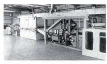
3-stufige Aquajet-Anlage für Standard- und Mikrofaservliesstoffe
