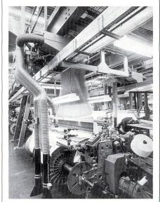
Reiniger SP 100 über Dornierwebmaschinen mit Jacquard.
