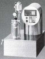
HT Färbeapparat für Web- und Wirkware, Garn, Strang und Flocke, Flottenumwälzung mittels Zahnradpumpe, Durchflussrichtung reversierbar, Optionen wie Regelsystem für Durchfluss und Differenzdruck, Dosieren, Flottenentnahme, pH-Steuerung
