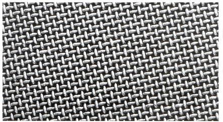
Schnittfeste Gewebe mit INOX. Neue Faser- und Gewebetechnologie ermöglicht einen sehr guten Schnittschutz. Gewebe dieser Art werden beispielsweise für Forststiefel eingesetzt und bilden dort einen Kettensägenschutz.
