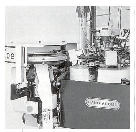
Sangiacomo mit einem Kettelaggregat an der Strickmaschine.
