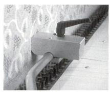
Abb. 3: Beim Auf- und Nachwell-System «QuickRoll» wird die Stofflinie durch neuartige Sensoren überwacht.
