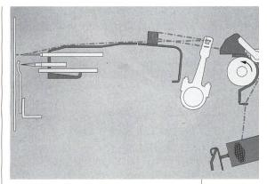
Abb. 2: Fadenverlaufs-Schema des positiven Fadenlieferungs-System «ActiFeed».
