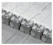
Abb. 4: Optische Fadenbruch-Anzeige «Opti-Point» an der Stickstelle.
