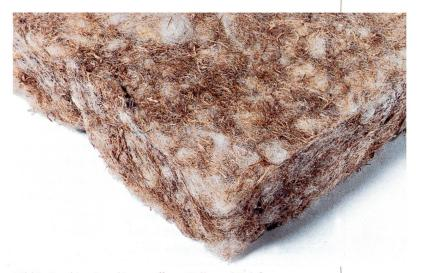
Bild 2: Kombinationsdämmstoff aus Wolle und Holzfasern.
