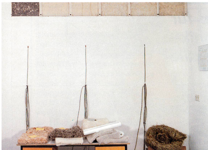
Bild 3: Messplätze zum Wärme- und Feuchtedurchgang durch Laborwände.
