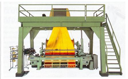
Bild 6: Die Greiferwebmaschine G6200, ausgestattet mit Jacquardmaschine und Steuerung für acht Schussfarben, vereint exklusive Musterungstechnik mit boher Leistung und hervorragender Gewebequalität.
