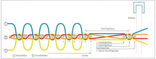
Bild 2: Aufbau und Entstehung eines 3-Schuss-Frottiergewebes.
