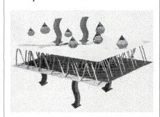
Dem monofilen, nicht feuchteleitenden Fadensystem wurde ein zweites, polyfiles Fadensystem zum Zweck des Feuchtetransportes hinzugefügt. Dabei spielt die Beschaffenheit dieses Fadenmaterials hinsichtlich Kapillarzahl, Fadenprofil und Feuchteleitvermögen eine grosse
