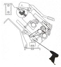
Reinigen der Spannelemente.
