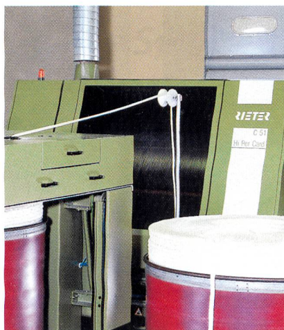
Ausgerüstet mit der Option Hi•Per•Card kann die Karde C51 bis zu einer Produktion von 100 kg/h eingesetzt werden.
